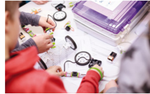
Die Elektronikbauteile LittleBits lassen sich variabel zu einfachen Schaltungen oder komplexeren Bastelprojekten zusammensetzen.
